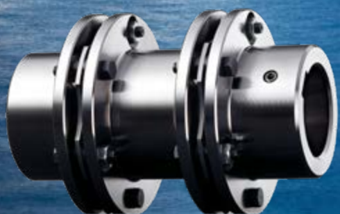
KTR ha messo a punto un nuovo design dei pacchi lamellari per giunti torsionalmente rigidi Radex-N. L'impiego di pacchi lamellari a 8 fori aumenta la capacità di coppia.
