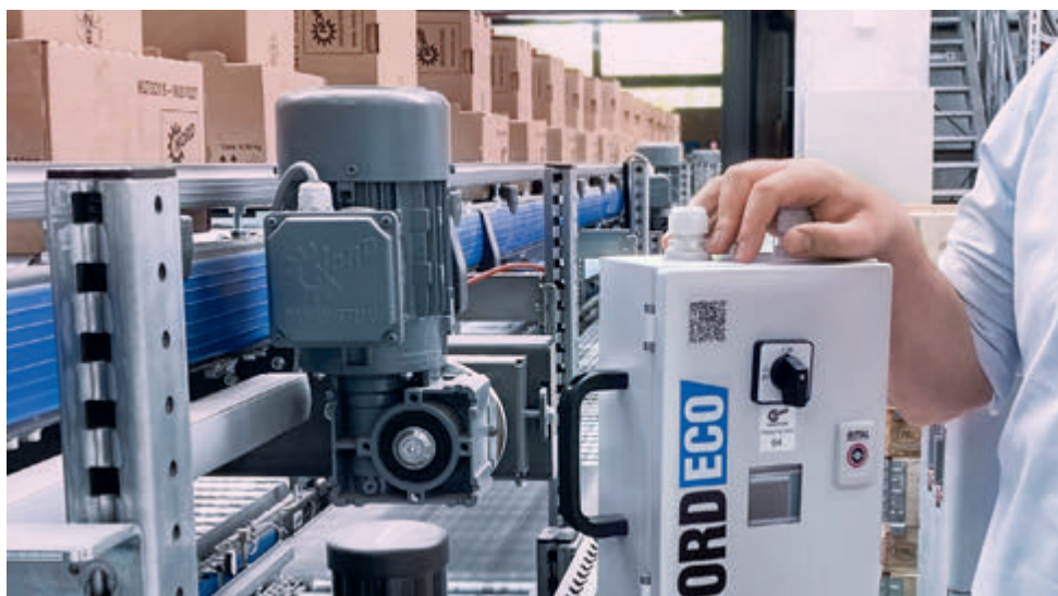
Duodrive motore IE5+ con inverter Nordac ON di Nord Drivesystems. Consulenza ingegneristica con Nord ECO - Energy and Carbon Emission Optimization.
