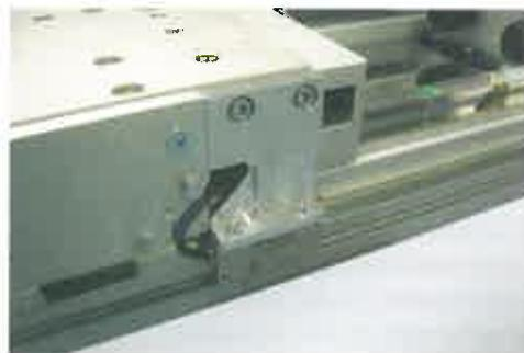
Dettaglio del sistema di misura lineare ottico aperto in versione assoluta realizzato da Heidenhain montato su un modulo MLM4
