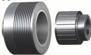
rotore limita la forza applicata. Il rotore interno è un mozzo in acciaio inossidabile su cui sono disposti i magneti permanenti nichelati. Il rotore esterno è costituito da un corpo in alluminio su cui sono posizionati gli anelli di isteresi. La nuova serie è attualmente disponibile in tre dimensioni per coppie di sovraccarico da 1,2 a 6 Nm con una
