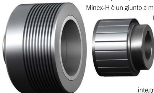
Minex-H è un giunto a magnetico permanente che trasmette la coppia in modo sincrono e senza contatto tra il rotore interno ed esterno tramite un campo magnetico. La particolarità di questo nuovo prodotto è la protezione da sovraccarico
