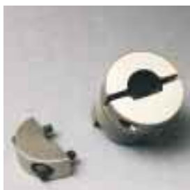
Calotte separabili per l'installazione del giunto flessibile laddove i componenti non possono essere rimossi per consentire il posizionamento del giunto sugli alberi
