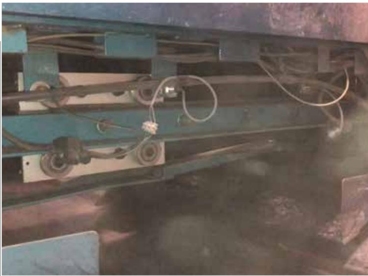
*Grazie alla caratteristica geometria del cuscinetto e della guida, i detriti vengono espulsi verso l'esterno del cuscinetto in un movimento a spirale, lontano dalla superficie di rotolamento*
