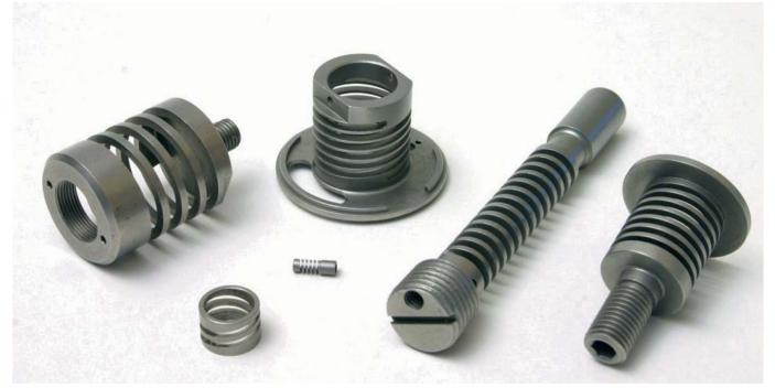
Le molle di precisione Helical sono lavorate da macchina utensile. Ricavate da un singolo pezzo, si adattano a ogni soluzione progettuale e sono disponibili in tutte le tipologie costruttive: a compressione/estensione, a torsione, a traslazione laterale, a flessione laterale
