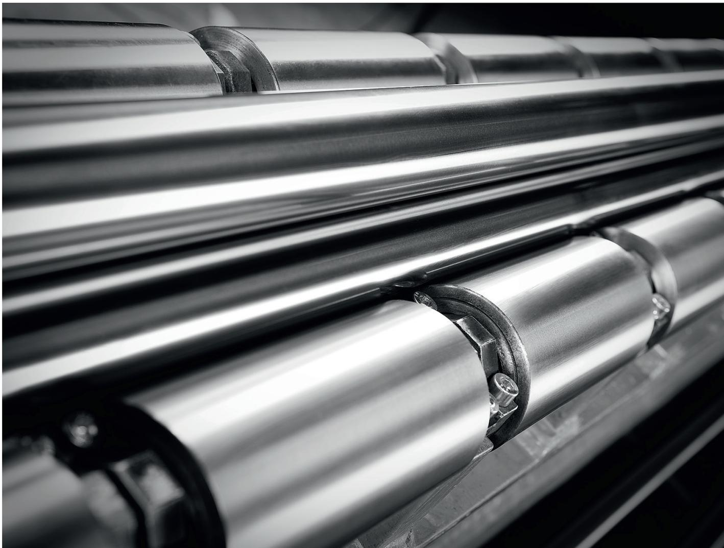
**Esempio di montaggio di controrulli Unitec a supporto del cilindro di spianatura per laminazione di nastro di acciaio.**
