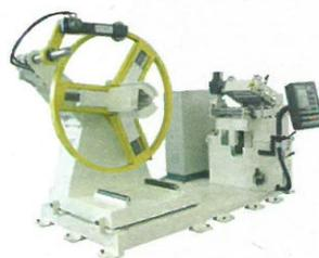
**Linee tradizionali** composte da aspo, raddrizzatrice e alimentatore utilizzate per presse veloci 100 -300 colpi/min. e per materiali delicati (inox, preverniciato, Al...)
