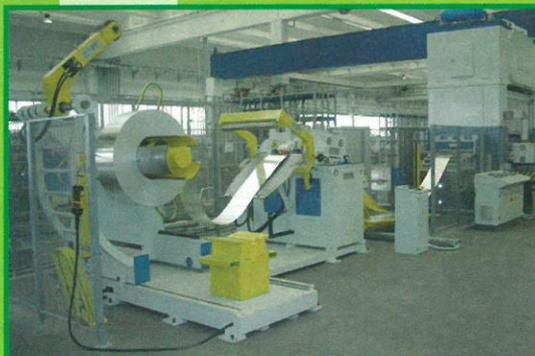
Linee di alimentazione per presse con aspi sino a 20 t di portata e diametri esterni sino a 2000 mm
