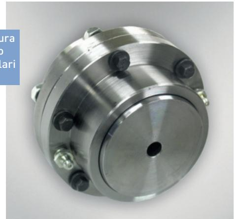
Giunti in acciaio GDM, dentatura arcuata e bombata, accettano disallineamenti radiali, angolari e spostamenti assiali.
