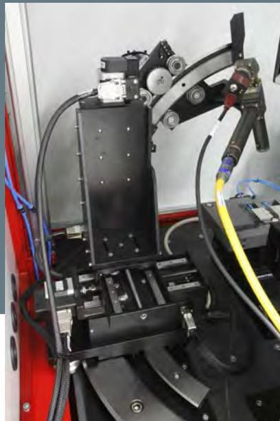
Il robot per saldatura Nanosystec può spostarsi su distanze di soli 100 nanometri, grazie a un sistema di guida fornito da HepcoMotion e distribuito in Italia dal Gruppo Mondial.
