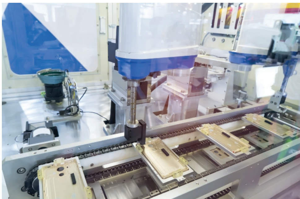
Robot SCARA per operazioni di assemblaggio.
