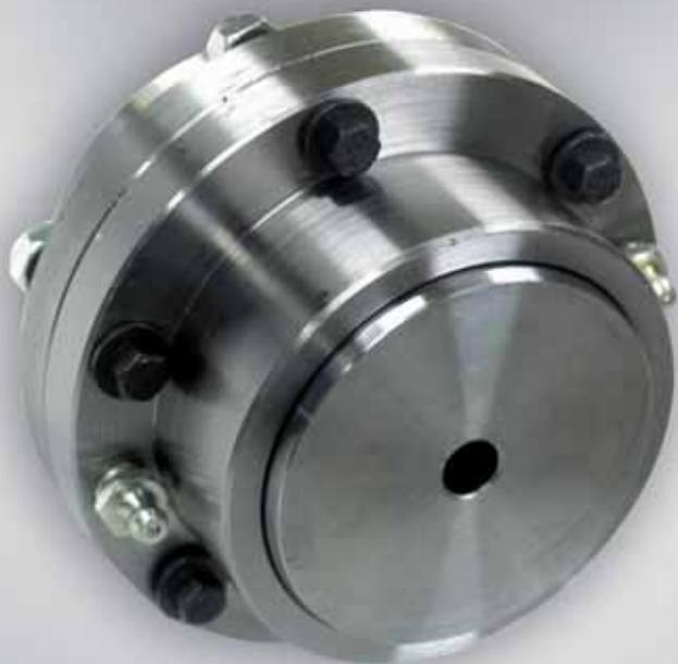
Giunti in acciaio GDM, dentatura arcuata e bombata, accettano disallineamenti radiali, angolari e spostamenti assiali.
