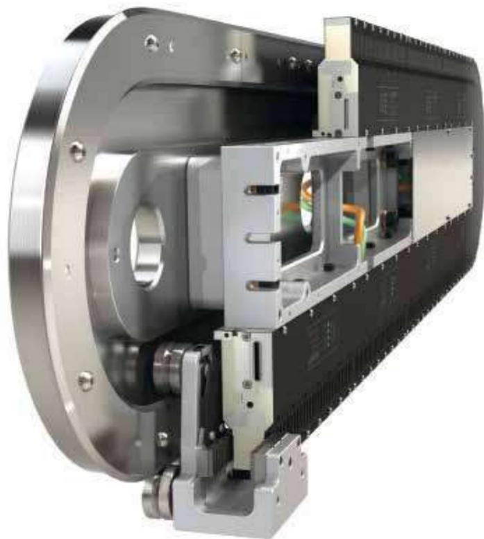
Le guide GFX di Hepco Motion, distribuite in Italia del Gruppo Mondial, massimizzano i risultati del sistema XTS di Beckhoff tramite l'impiego di guide a doppia cuspide e di mover con rotelle in acciaio, autopulenti e con profilo a 'V', declinati in vari modelli e capaci di sostenere un payload fino a 10 kg
