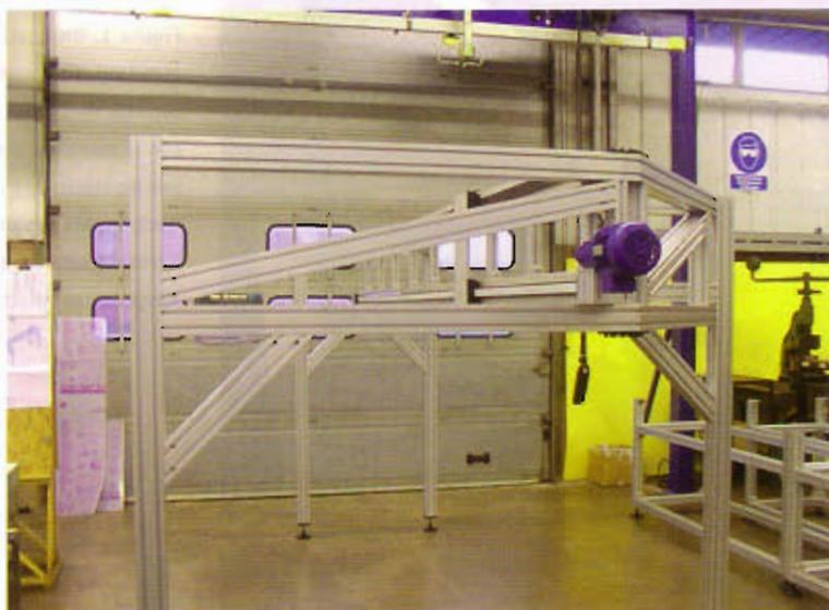
Figura 2. Un telaio MCS con una unità di guida DLS, parallelo a un sistema di asservimento utilizzato per la movimentazione di carrelli in acciaio.
