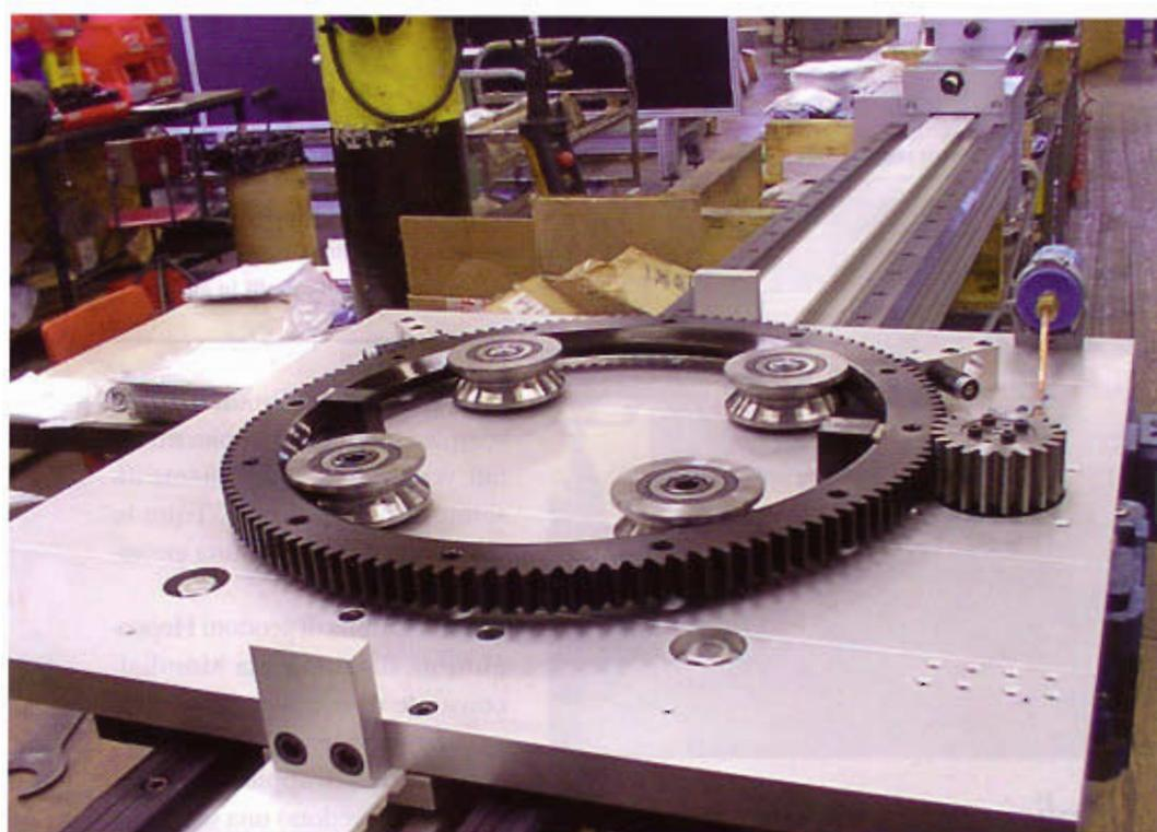
Figura 1. Un anello standard HD fissato al carrello dell'unità HDLS con comando a cinghia per movimentare componenti pesanti che devono ruotare quando vengono installati.
