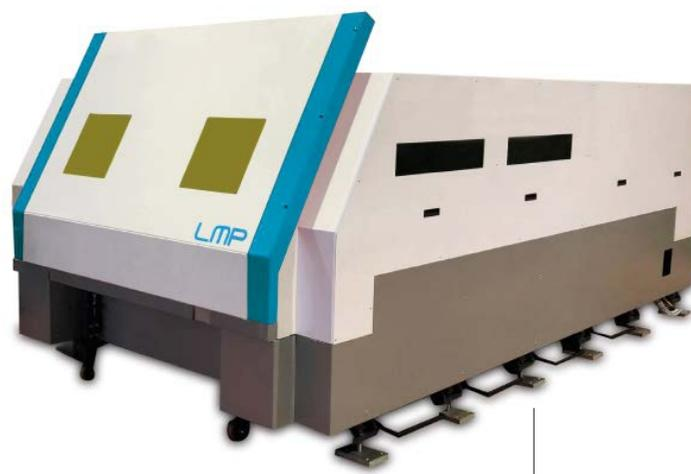
Sulla base della serie Lme, Cutlite Penta ha sviluppato anche la gamma Lmp, che utilizza laser a CO<sub>2</sub> di Potenza media e al cui interno usa i moduli a motori lineari Mondial MLM7N
