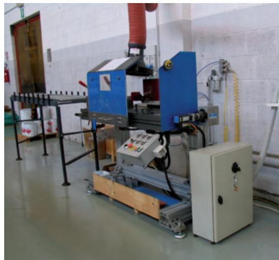
**La macchina per il rinvenimento dei terminali delle guide progettata e realizzata da Mondial.**
