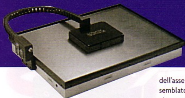
▲ SISTEMA DI POSIZIONAMENTO X-Y REALIZZATO CON MOTORE PLANARE PASSO-PASSO. LA MOVIMENTAZIONE È SENZA CONTATTO SU CUSCINO D'ARIA
