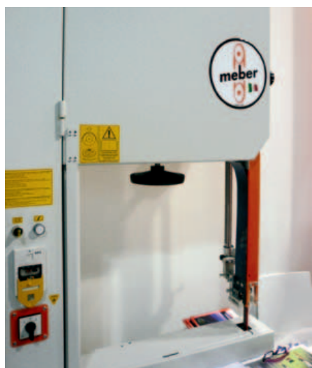
Una segatrice verticale per il taglio del legno, alluminio, bronzo e ghisa. Una segatrice per metalli duri, acciai e altri materiali speciali.
